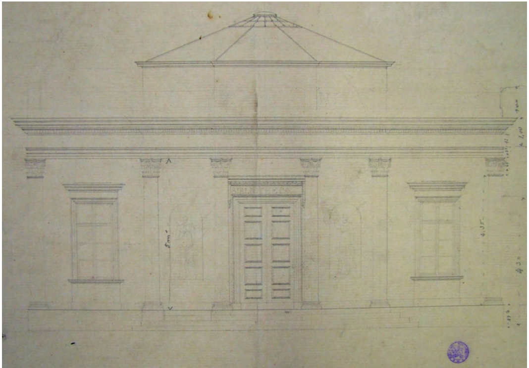
Fig.14. Voorontwerp van Roelandt voor de nieuwe vestibule uit 1818. Merk de nissen voor beeldhouwwerk op naast de hoofdingang, die later verdwenen uit het ontwerp. (UG, kaartenzaal, map 'bibliotheek van de universiteit')
